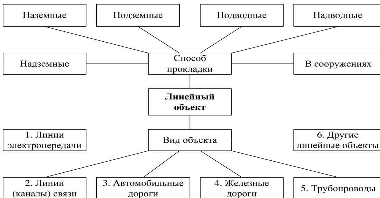
Рис. 1. Классификация линейных сооружений
