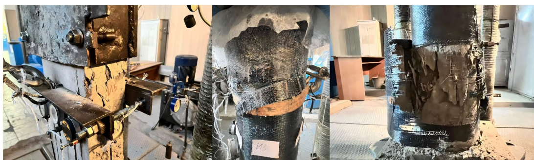
Рис. 3. –Сравнительная схема зон окончательного разрушения трёх экспериментальных образцов
