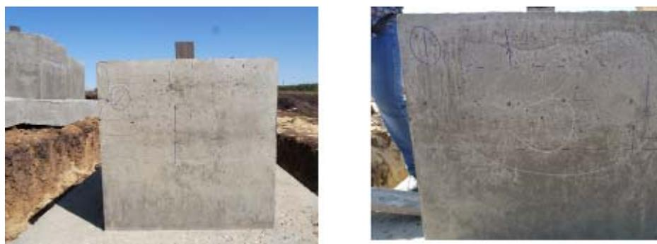
Рис 7. – Отсутствие дефектов после нагружения несущих конструкций
