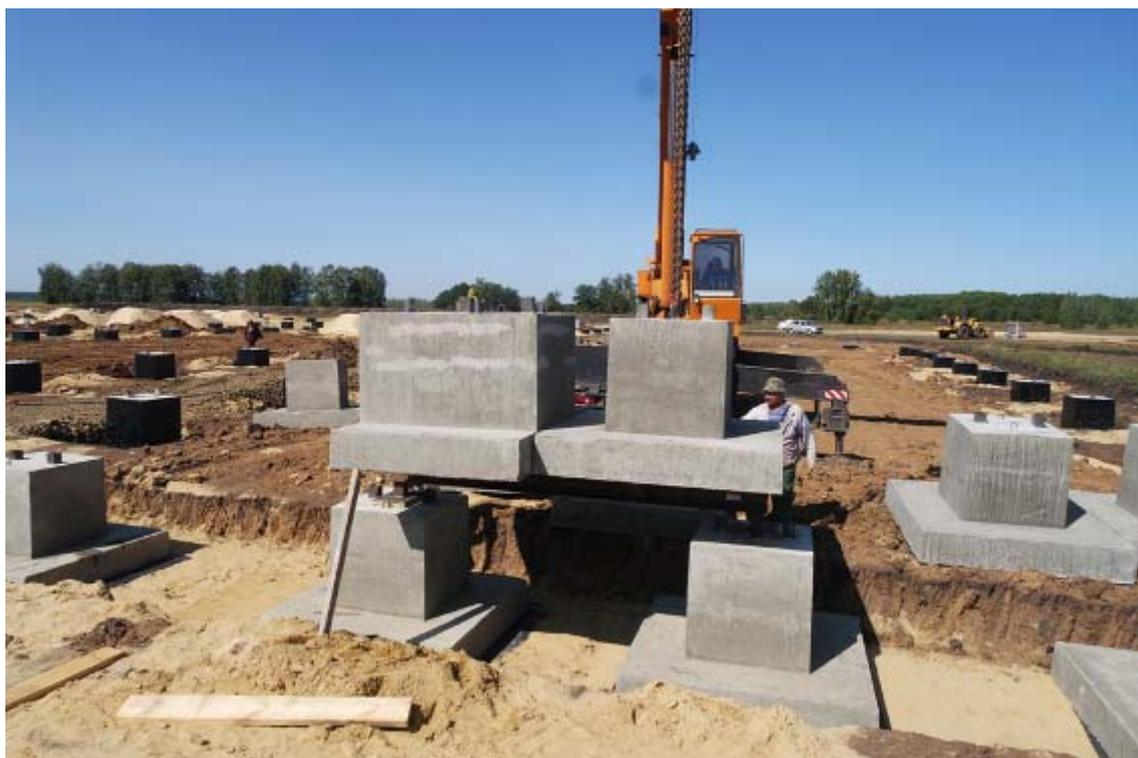
Рис. 5. – Испытание фундаментов ФМЗ
