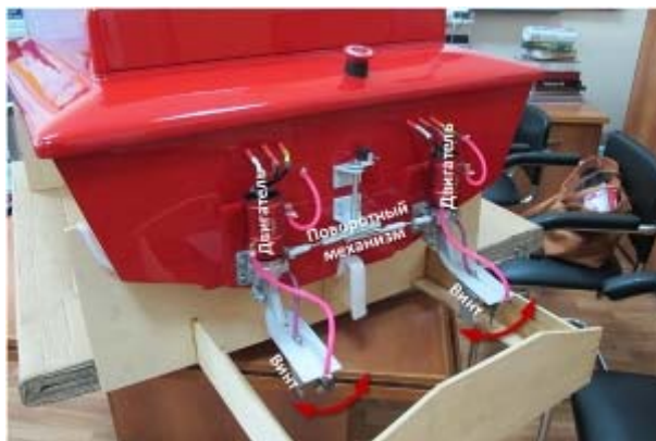
Рис. 4. – Движительный рулевой комплекс мини-корабля
