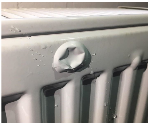
Рис. 3 – Подплёночная коррозия стальных панельных радиаторов
