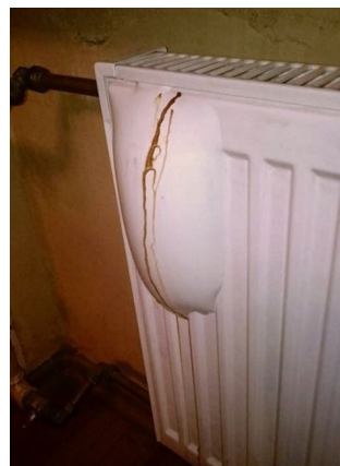
Рис. 3 – Подплёночная коррозия стальных панельных радиаторов
