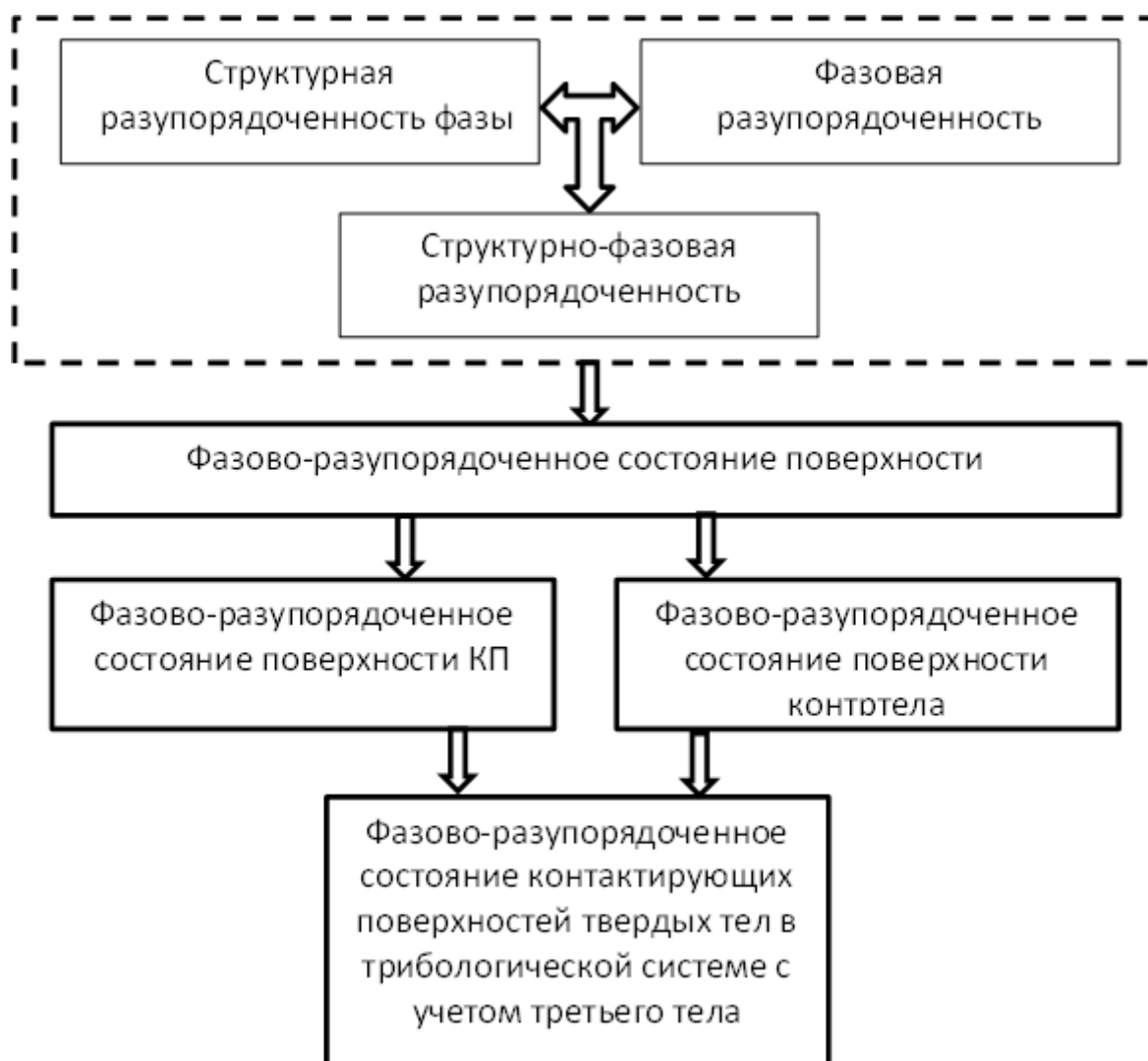
Рис. 2. Система фазово-разупорядоченного состояния поверхностей трения ТС
