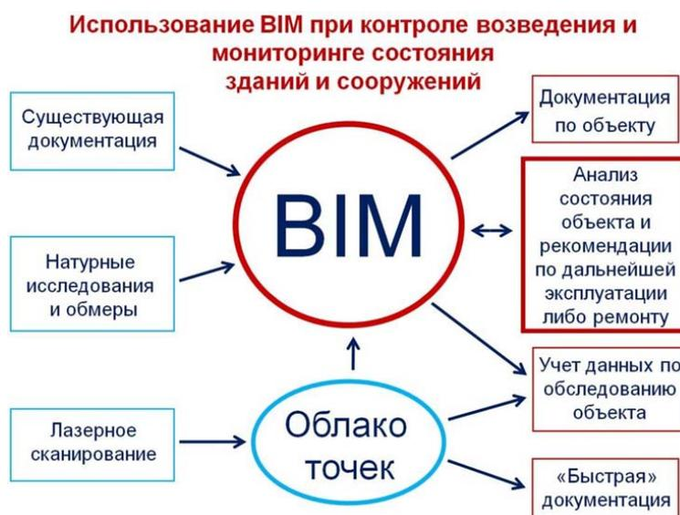
Рисунок 1. Роль информационной модели при контроле состояния объекта [3]
