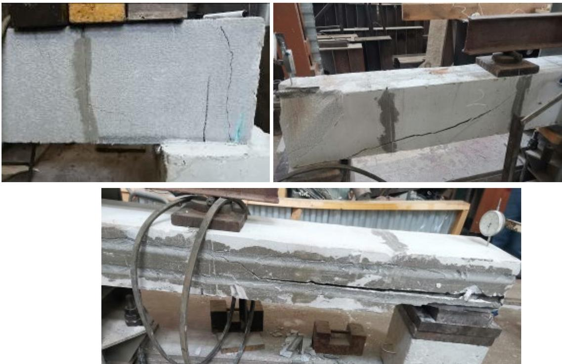
Рис. 7. – Разрушение газобетонной перемычки (Схемы 1, 2 и 3 соответственно)
