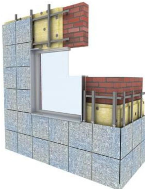
Рис. 2. - Вентилируемый фасад с облицовочным материалом из плит керамогранита [6]
