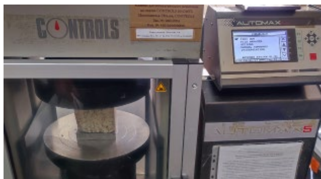
Рис. 2. – Общий вид испытания образцов на сжатие
