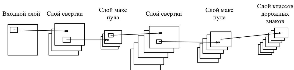
Рис. 1. – Архитектура сверточных ИНС для определения знаков дорожного движения
