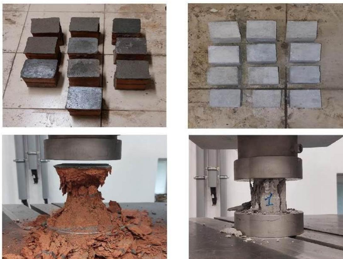
Рис. 6. Эксперименты кирпича керамического и растворной смеси на сжатие
