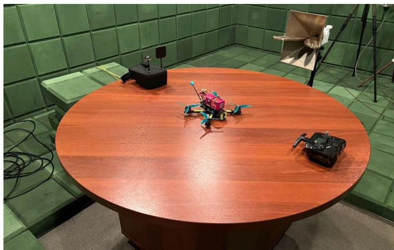
Рис. 2. – Фото размещения оборудования в БЭК
