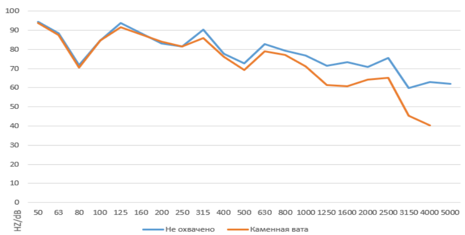
Рис. 2. Уровни звукового давления в Y-образном экране с заполнением и без него для разных частот
