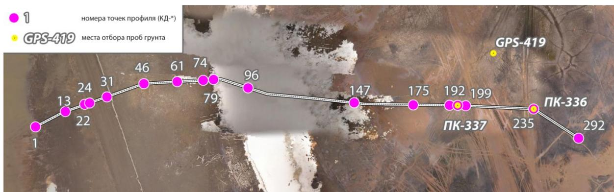
Рис. 1. - Схема георадарной трассы выполненной 13.07.19. на фоне аэрофотоснимки.
